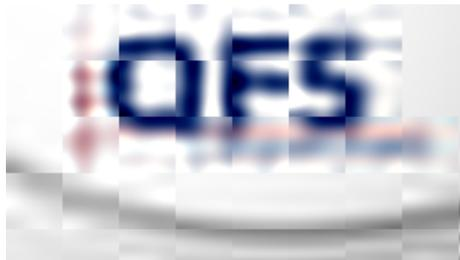
Abbildung 59.9: Blockbildung zur Bildanalyse mittels Diskreter Kosinustransformation
