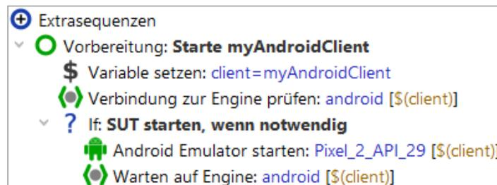
Abbildung 16.12: Vom Schnellstart-Assistenten erzeugte Startsequenz für den Android-Emulator
