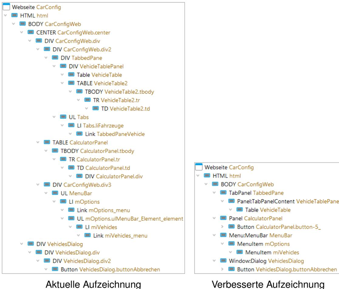
Abbildung 51.18: Verbesserte Komponentenaufzeichnung am Beispiel des "CarConfigurator Web"
