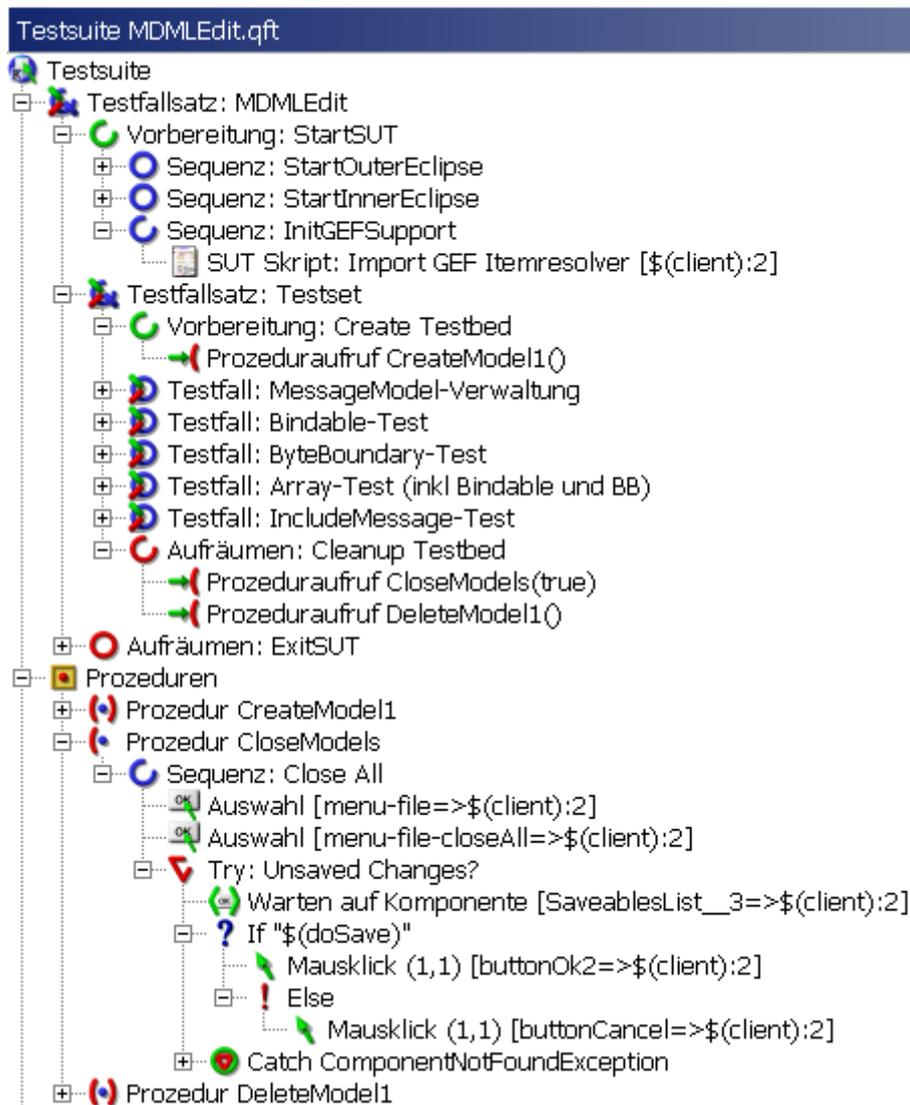
Abbildung 3.4: Der Aufbau der Testsuite für MDMLEdit
